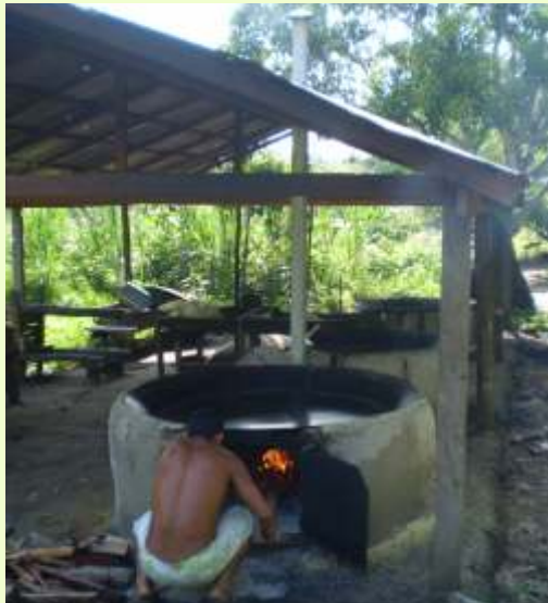
Abaixo: forno ecoeficiente para casa de farinha na Amazônia
