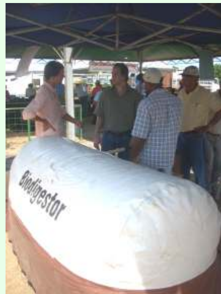
Um biodigestor produz gás e fertilizante a partir de água e esterco, além de proteger o meio ambiente
